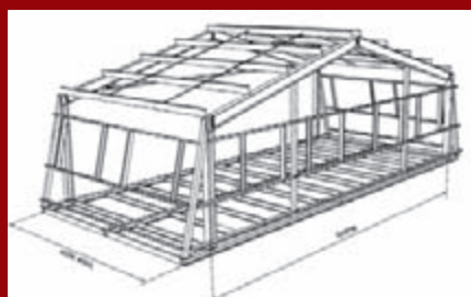
Prostorové uspořádání ocelové konstrukce nástavby.
